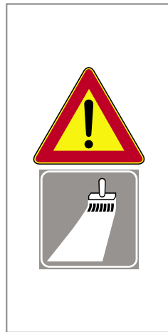
Fig. 391 Segni orizzontali in rifacimento
