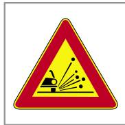
Fig. 390 Materiale instabile sulla strada
