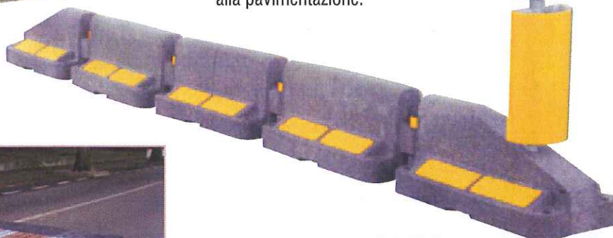
Eleganti elementi New Jersey altezza 40 cm, lunghezza 100 cm, larghezza alla base 40 cm, peso 60 kg da tassellare alla pavimentazione.
